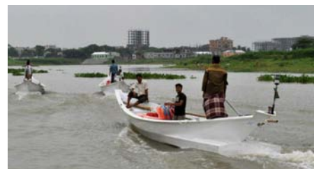
Ci-dessus: les bateaux de pêche «masdoris», construits par l'ONG Friendship en fibre de verre, remplacent avantageusement les embarcations traditionnelles en bois, d'une durée de vie très limitée. Leur forme n'est pas sans rappeler celle de Tara Tari .
