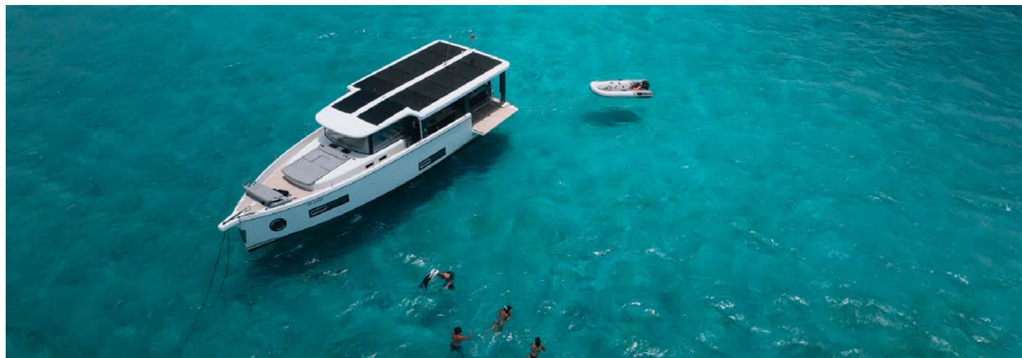
Bateau de la marque Jeanneau (Groupe Beneteau), le Sea Loft 480 propose une autonomie électrique de 15 milles nautiques à 7 nœuds, et une autonomie hybride de 250 milles nautiques. Grâce à sa batterie de 30 kWh et ses panneaux solaires de 4,2 kW, il permet de profiter de la mer sans bruit et sans contrainte. GROUPE
